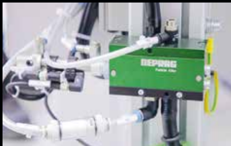
DEPRAG particle killer: Z podavače jsou cíleně odváděny částice nečistot
